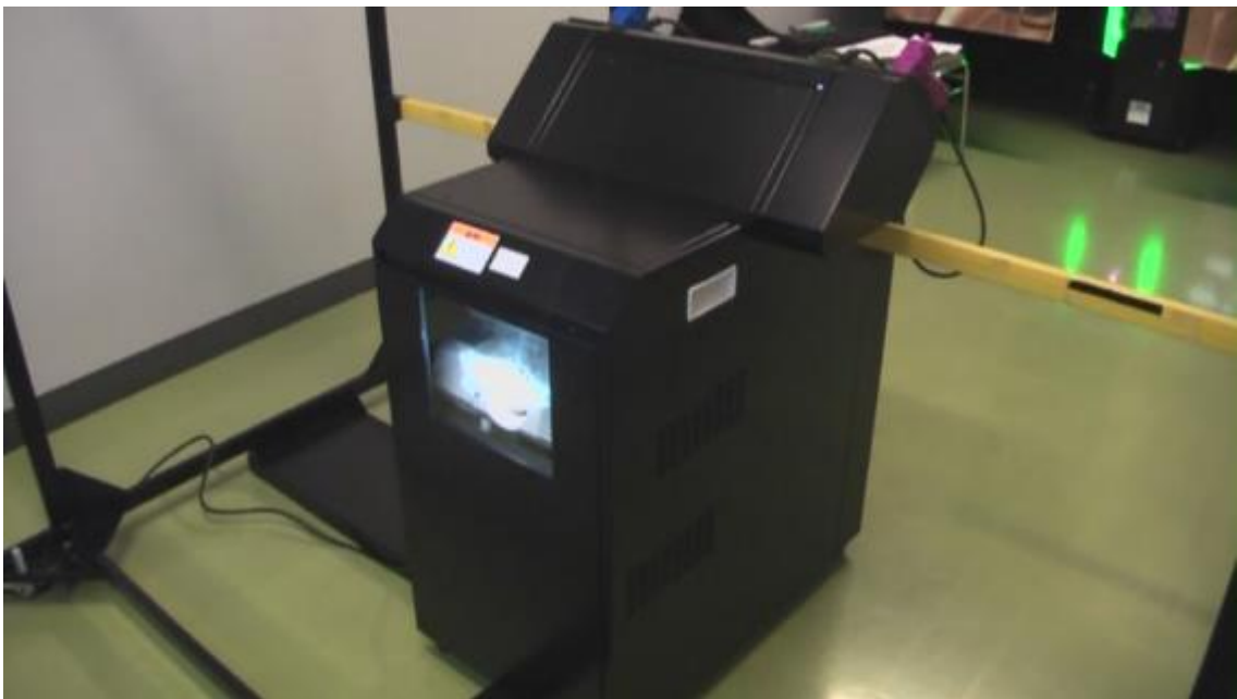
→ 컨트롤러 거치대의 전체 측면 모습(거치대 내부에 빔프로젝터가 내장되어 있음.)
