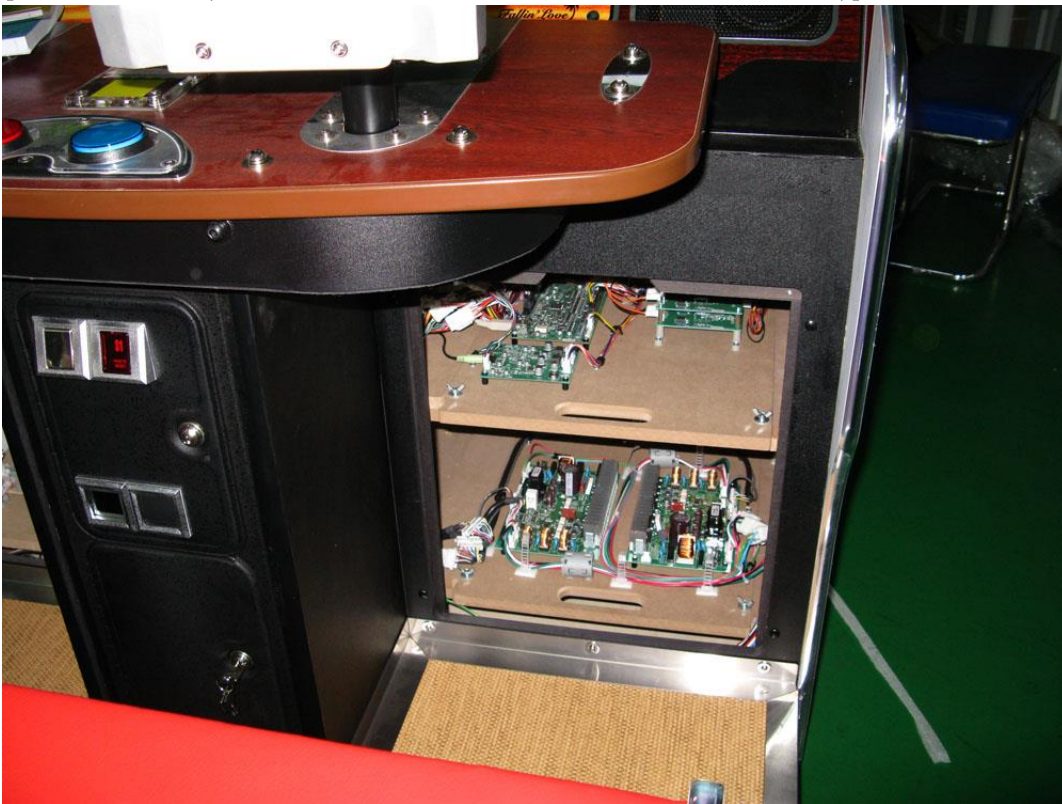
[내부 사진 10 (메인보드 + I/O 보드+사운드 보드+건 진동보드)]
